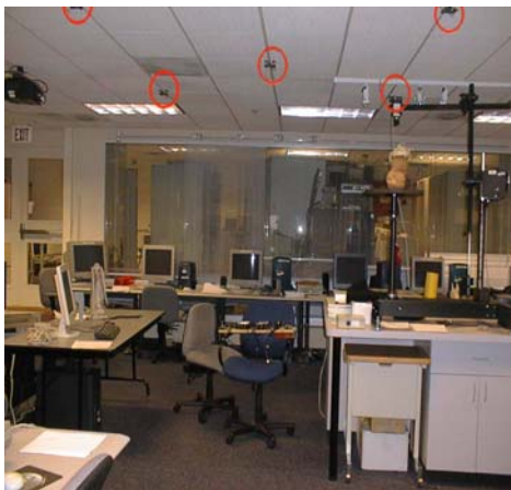
شکل (۱-۷) گیرنده های سقفی در سیستم Cricket
